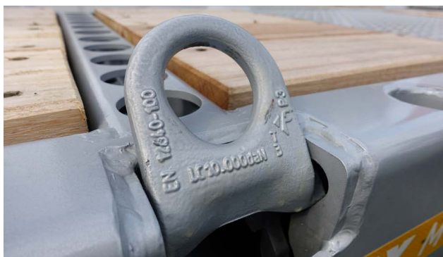
Exempel på surrningspunkter i flakkanten på två olika maskintrailers; LC 5 000 daN (5 ton) respektive LC 10 000 daN (10 ton). Eftersom det är fast monterade fästen är det en pragmatisk tolkning att även infästningen av fästet i fordonet har samma styrka.
