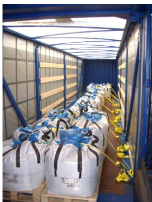
Exempel på säkring av storsäck med hjälp av överfallssurrning.
