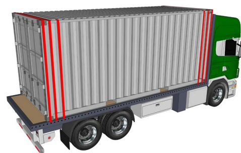
Tomcontainer (2,6 ton) med gummimellanlägg men med frost på flaket säkrad med 6 överfallssurningar.
