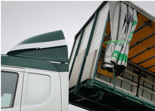
Typiskt slagprovad framstamskonstruktion.
