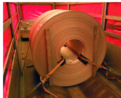
Exempel på rulle i fast vagga förstängd med stöttor.
