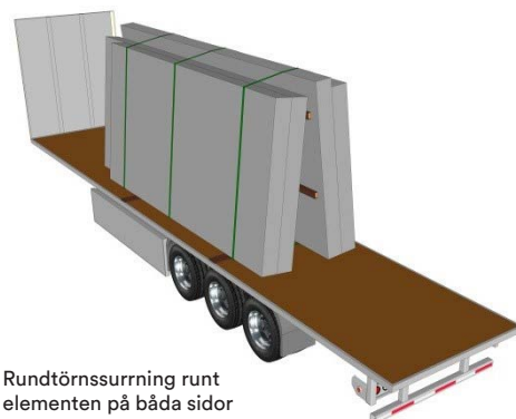
Bock med rät vinkel som förhindrar glidning i sidled.
